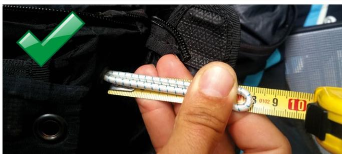
Si les élastiques mesurent plus de 8 cm, ils doivent être remplacés par de nouveaux élastiques de la bonne longueur.
